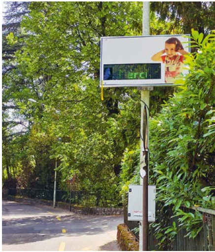
Le radar anti-bruit et son panneau qui affiche en temps réel un «Merci» si la limite de 83 décibels n'est pas dépassée
