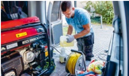
Ce véhicule a été équipé d'une génératrice et d'une citerne d'eau d'une capacité de 400 litres pour pouvoir intervenir partout
